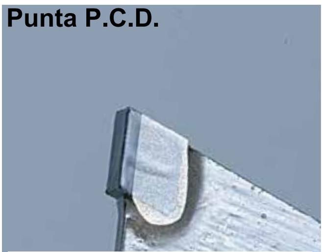
PCD (Diamante Poly-Cristalizado) las pastillas son extremadamente fuertes con gran resistencia. Las pastillas PCD de los discos de corte son la mejor opción para un rendimiento de larga duración al cortar tableros de fibrocemento.
