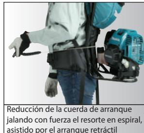
Reducción de la cuerda de arranque jalando con fuerza el resorte en espiral, asistido por el arranque retráctil
