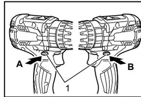
1. Palanca del conmutador de inversión de giro
