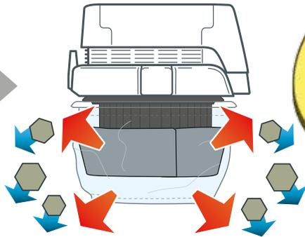
Cuando la alimentación está apagada, el amortiguador se expande de nuevo a su tamaño original y sacude el polvo del prefiltro automáticamente con su potencia de expansión.
