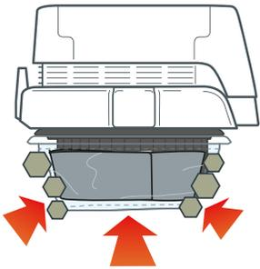
Cuando se conecta la alimentación, el prefiltro se contrae por sí mismo para comprimir el amortiguador, y se ajusta estrechamente sobre el amortiguador y el filtro de polvo.
