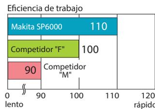
**Material de prueba:** Tabla de madera de ancho 60mm y grueso de 40mm,
