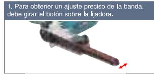
1. Para obtener un ajuste preciso de la banda, debe girar el botón sobre la lijadora.
