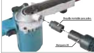
Extracción directa de polvo desde la lijadora (Ver figura) garantizando un trabajo eficiente y libre de polvo. Utilice Boquilla montable para polvo y Manguera 28 (Manguera de 28 mm de diámetro).
