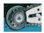
Bomba de aceite de metal ajustable para una mejor lubricación de la cadena.
