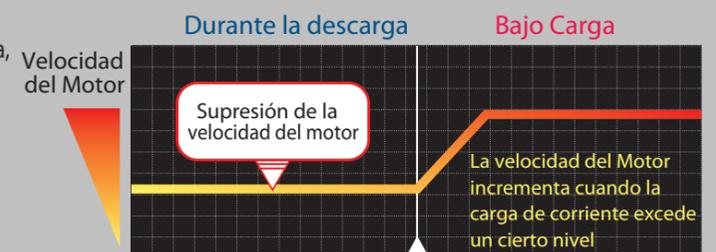
La velocidad del Motor incrementa cuando la carga de corriente excede un cierto nivel cuando empieza a romper
