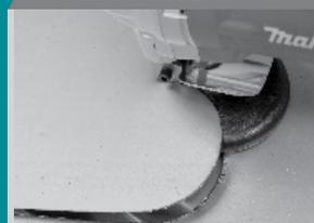
Radio mínimo de corte de 2" (50mm).
