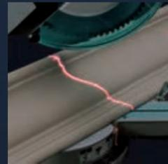
El láser emitido es montado en la guarda del disco, minimizando el desalineado entre la línea de referencia láser y la línea de corte actual.
