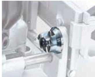
La profundidad de corte se puede ajustar en 6 posiciones con sólo girar la perilla de ajuste de profundidad.
