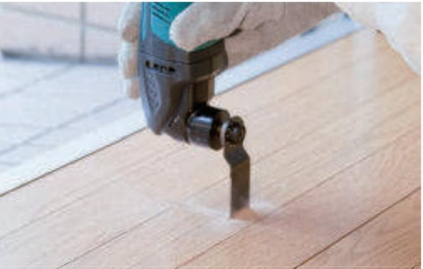
Cortes de penetración profunda.
