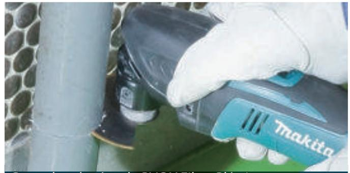
Corte de tuberías, de PVC Y Fibro Plásticos Reforzados. TMA001~TMA004
