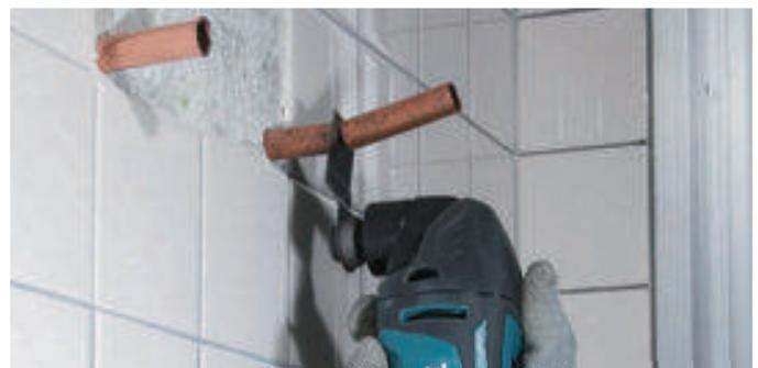
**Cortes en tubo de cobre TMA015, TMA016**
